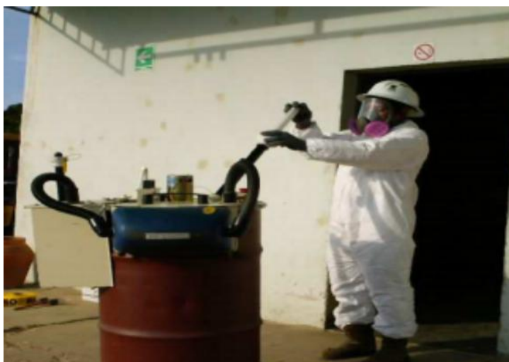
Figura 15 Recuperación del gas de mercurio para ser estabilizado
