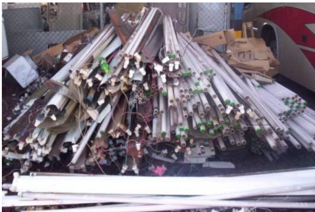
Figura 10 Almacenamiento inadecuado de los equipos de iluminación.
